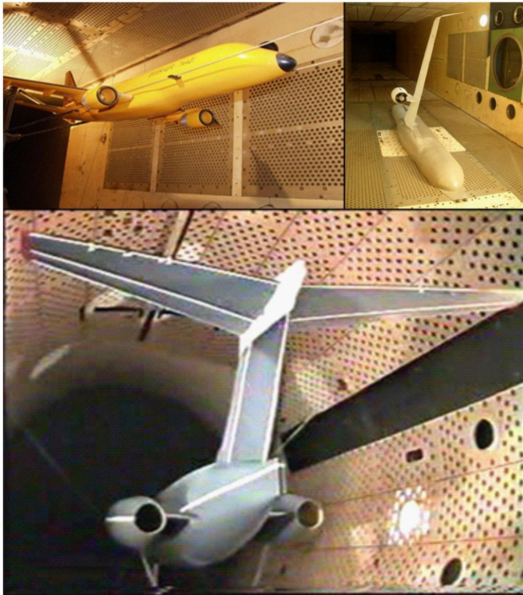
Рисунок 3 – Фотографии: ДПМ самолёта на «плавающей» подвеске, ДПМ хвостовой части самолёта, многофункциональная дренированная ДПМ модель крыла большого удлинения
