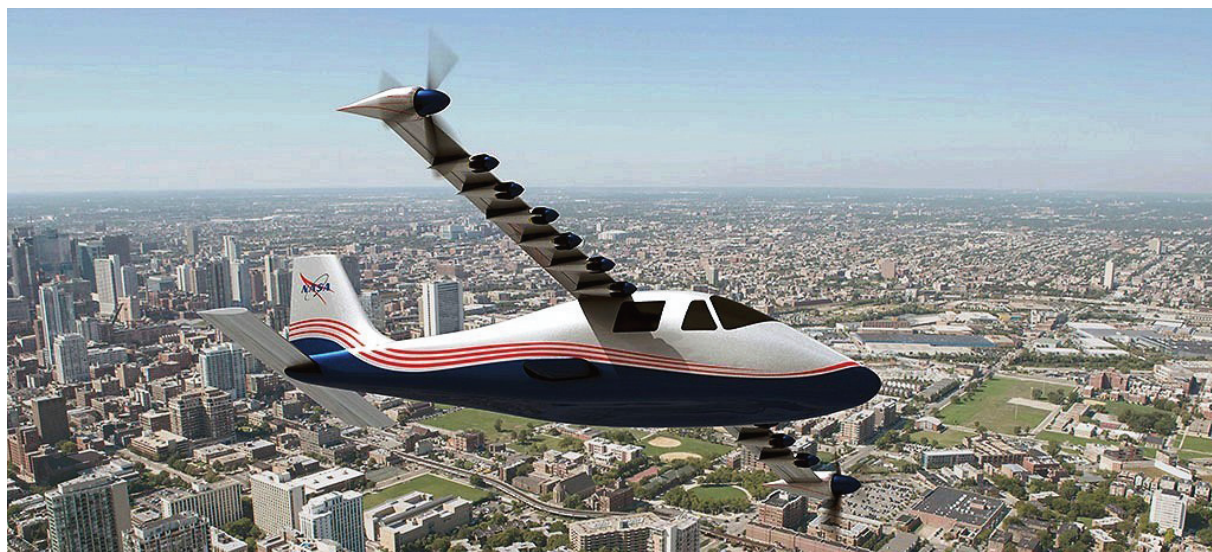
Рис. 5. Проект NASA легкого самолета с распределенной силовой установкой и маршевыми концевыми винтами
