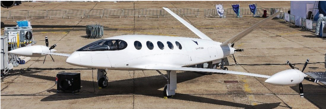
Рис. 6. Экспериментальный пассажирский самолет с электродвигателями и концевыми винтами в толкающей схеме
