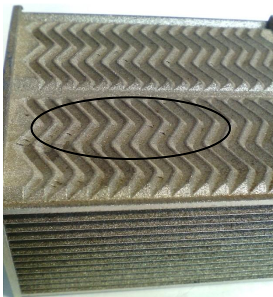
Рис. 9. Дефекты изготовления, выявленные при испытании образца (для горячего контура).
