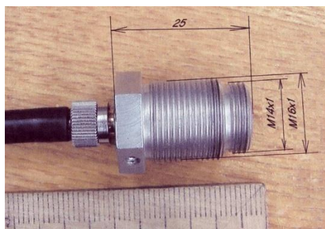
Рис. 2. Фотография микрочип-лазера, вмонтированного в штанцер.
