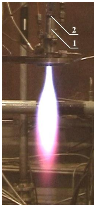
Рис. 6. Фотография факела при работе ЛЗУ на компонентах O_2+C_2H_5OH при G_{\Sigma}=7,8 г/с, \alpha=0,64 , \Delta\tau_F = 0 . 1- корпус запальника; 2 - оптический разъем подвода излучения накачки к микрочип-лазеру.
