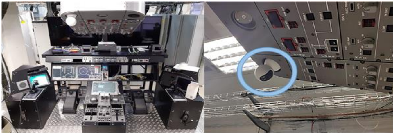
Рисунок 6 – Стенд интеграции авионики и камера, расположенная на нем
