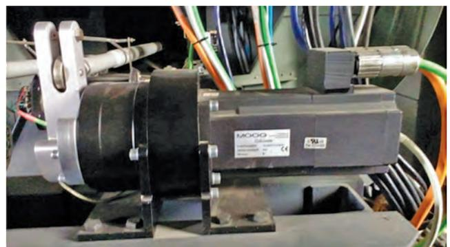
Рис. 2. Система моделирования усилий MOOG
