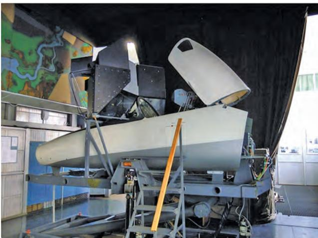
Рис. 1. Пилотажный стенд ТЛ-39
