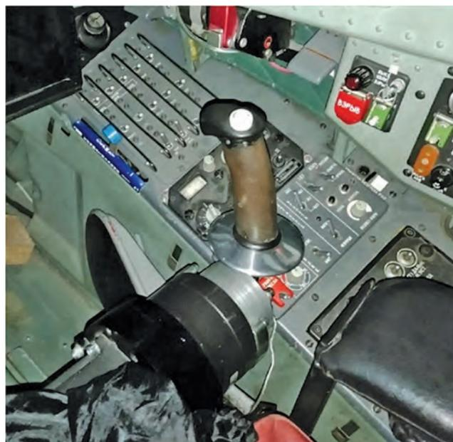
Рис. 4. Боковой рычаг управления
