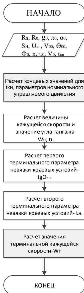
Рисунок 1 – Алгоритм расчета номинальных параметров движения БЛА.
