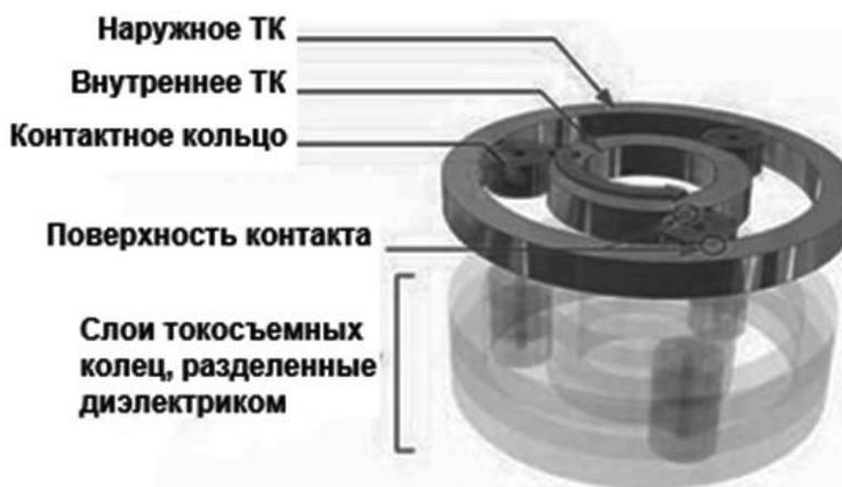
Рис. 1 Схема кольцевого токосъемного устройства
