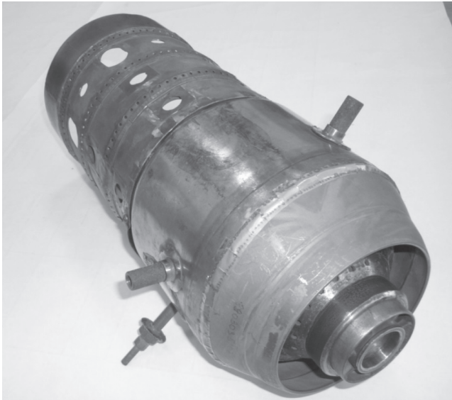
Рис. 5. Общий вид жаровой трубы модельной камеры сгорания
