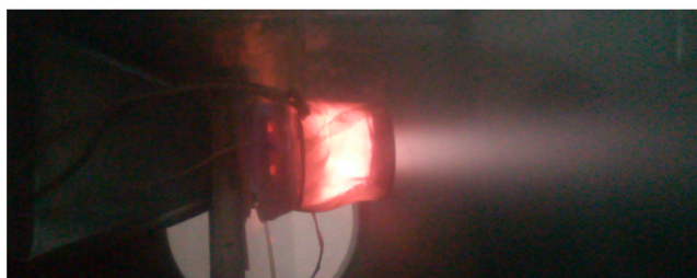
Рис. 9. Пучок ионов при потенциале эмиссионного электрода +600 В
