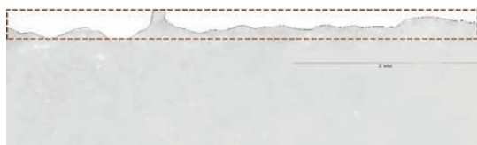
Рис. 4. Профиль поверхностного слоя образца, полученного методом SLS-печати
