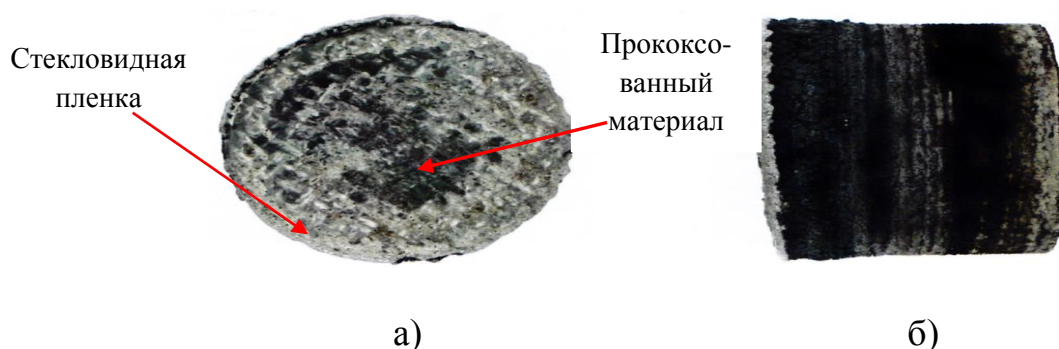
Рис. 18. Фото поверхности цилиндрического образца из внутреннего теплозащитного материала «Искрин-2» после испытаний, где:
