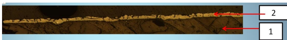
Рис.23. Микроструктура карбидокремниевого покрытия SiC, нанесенного тройным силицированием на детали регулятора из УУКМ марки "МКУ" (100 кратное увеличение), где:
