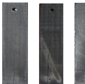
Рис. 29. Фото передней, тыльной и профильной поверхностей модельного образца с системой теплозащиты из УУКМ с объемным и поверхностным насыщением карбидом кремния при толщине покрытия SiC ~ 100 мкм после десяти циклов нагружения
