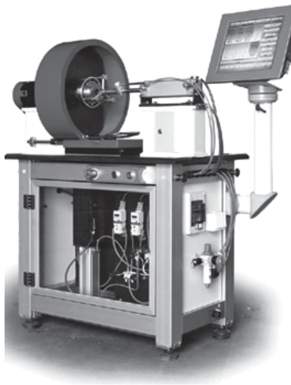
Рис. 2. Стенд входного контроля подшипников СП-180М
