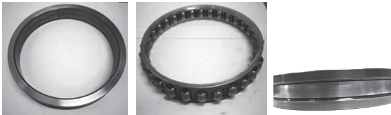
Рис. 8. Кольца и тела качения и сепаратор подшипника после окончания исследования
