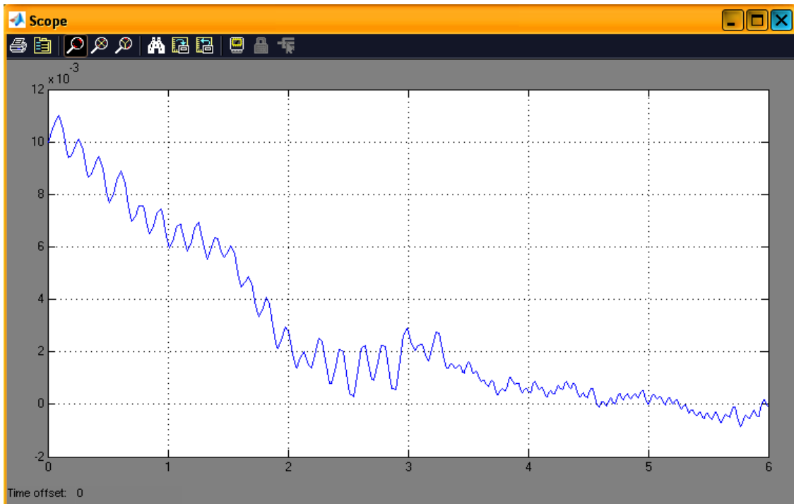
Рис.6. Процесс y_1(t) = y_2(t) = y(t) при начальных условиях \| 0.01, 0, 0, 0, 0, 0 \|^T
