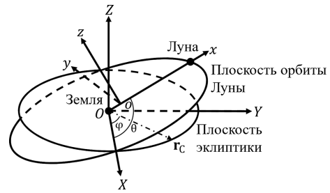
Рис. 1. Инерциальная система координат OXYZ и вращающаяся система координат oxuz
