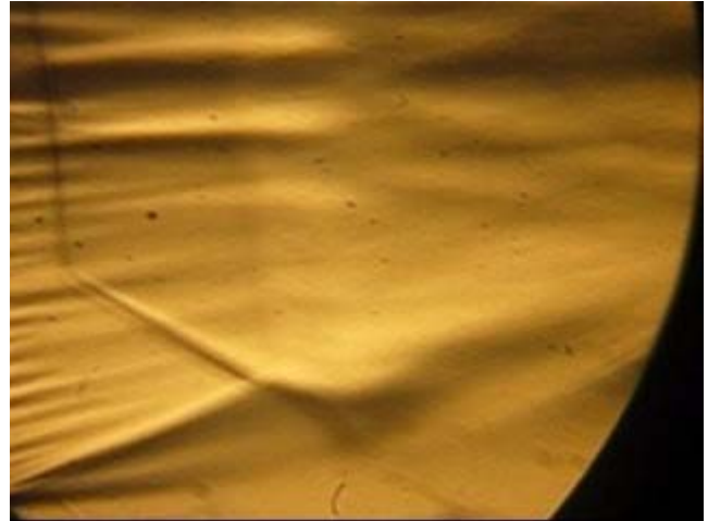
Рис. 11. Теневая картина ударно-волновой структуры в истекающей из модельного сопла струе (срез сопла слева)
