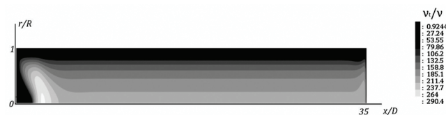
Рис. 10. Распределение относительной турбулентной вязкости \nu_{turb}/\nu в полости между разделительными пробками, находящимися на расстоянии x/D = 35
