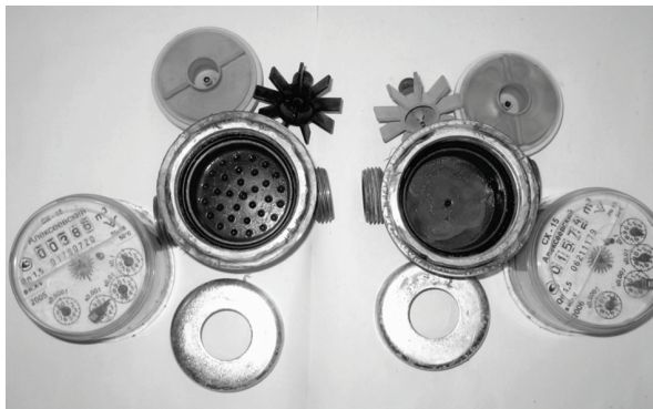
Рис. 3. Корпусы водосчетчиков для систем водоснабжения с полусферическими лунками (слева) и без лунок (справа) после ресурсных испытаний в течение года
