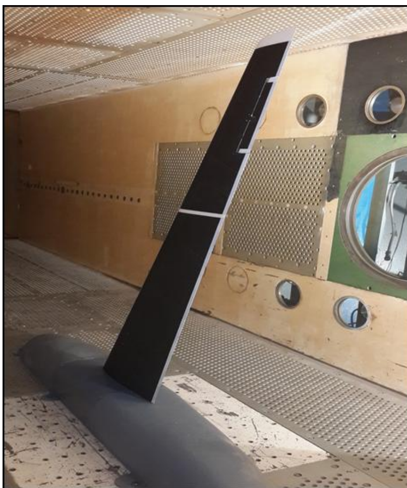
Рисунок 3 - Эталонная дренированная ДПМ нового поколения крыла большого удлинения
