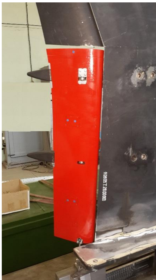
Рисунок 7 – Дренированная ДПМ нового поколения внутренней секции закрылка установленная на аэродинамическую полумодель
