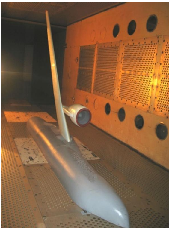
Рисунок 1 – Многофункциональная динамически подобная дренированная модель крыла большого удлинения
