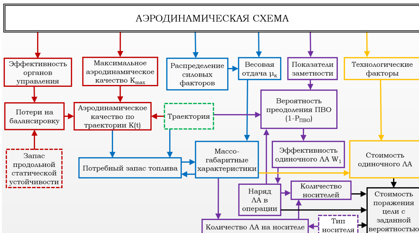
Рисунок 1 – влияние выбора аэродинамической схемы на проектные параметры летательного аппарата
