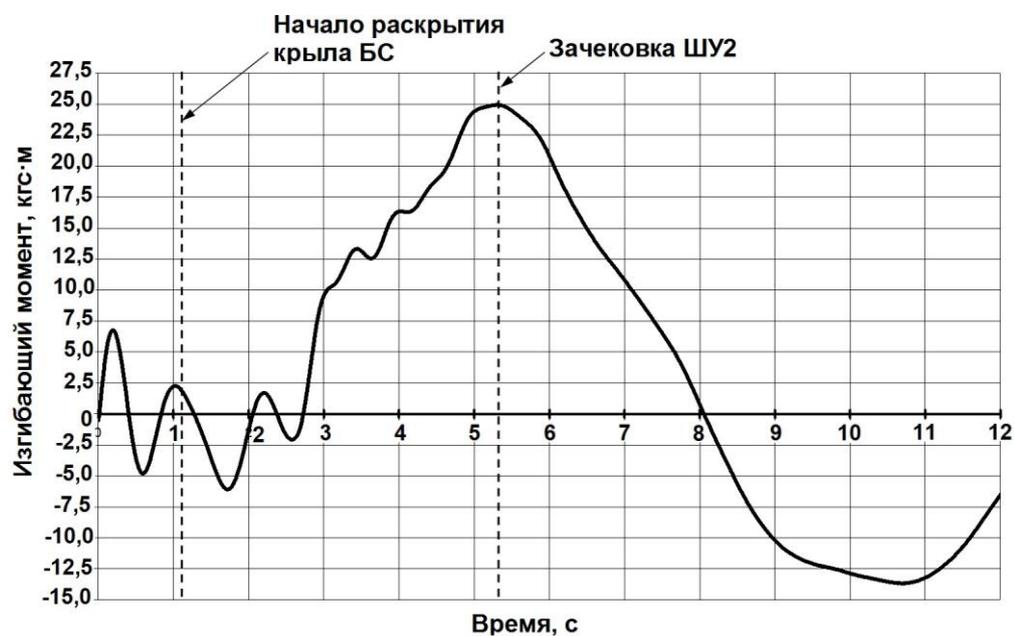
Рис. 3. График изгибающего момента, полученный по результатам расчета
