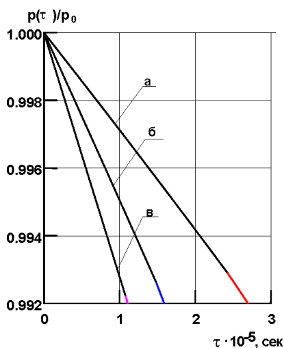
Рисунок 3. Зависимость времени разгерметизации отсека от его свободного объема L=10^{-3} м; h=1 а) \sigma=1,0 ; б) \sigma=1,5 ; в) \sigma=2,0 .
