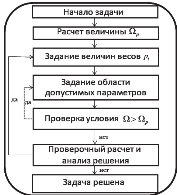
Рис. 6. Схема определения допустимых значений параметров асимметрии
