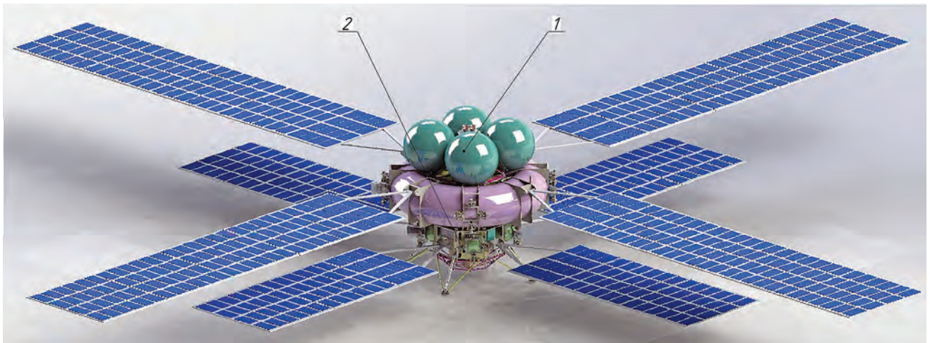
Рис. 4. Внешний облик демонстратора УКП, 1-е исполнение: 1 — аппарат-доставщик; 2 — спускаемый аппарат
