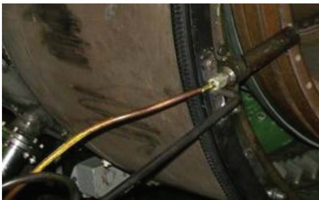
Рис. 7. Схема установки: а — газоотборный зонд; б — гребенка термопар
