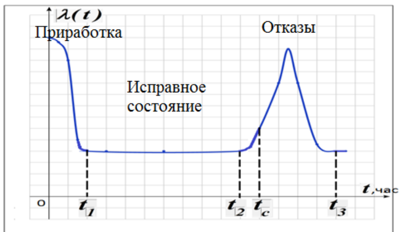
Рис. 1. Зависимость интенсивности отказов от времени эксплуатации двигателя.
