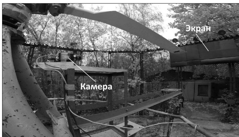
Рис. 5. Расположение экрана на экспериментальной установке
