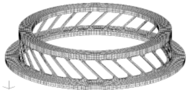
Рис. 5. Модель упругой втулки с наклонными прорезями
