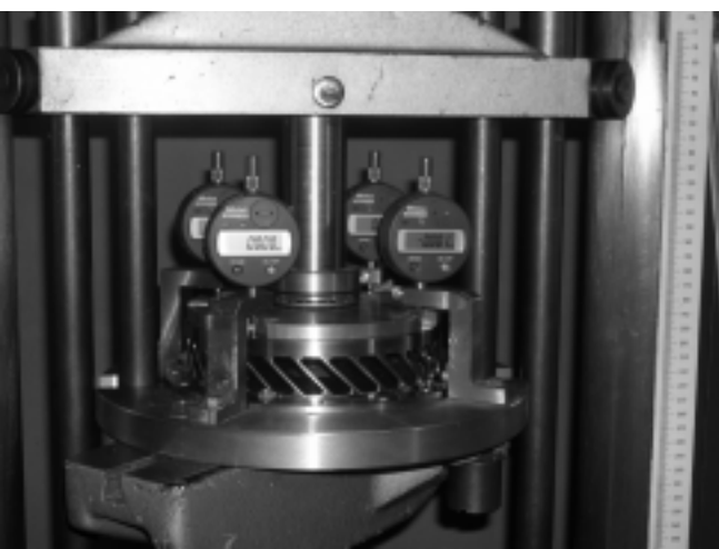
Рис. 6. Общий вид установки для проведения статических испытаний упругой части промежуточной опоры
