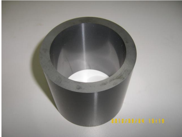
Рис. 7 Слева износостойкая втулка из наноструктурированного дисперсно-упрочненного карбида кремния для подшипника скольжения редуктора привода вентилятора авиационного двигателя НК-93 конструкции ОАО «Кузнецов».
