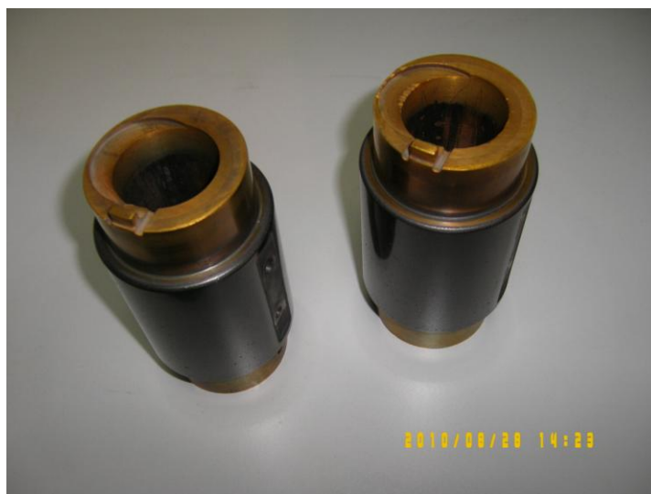
Рис. 6 Валы редуктора привода вентилятора авиационного двигателя НК-93 конструкции ОАО «Кузнецов» с покрытием из наноструктурированного дисперсно-упрочненного карбонитрида титана.
