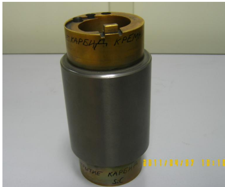
Рис. 8 Вал редуктора привода вентилятора авиационного двигателя НК-93 конструкции ОАО «Кузнецов» с защитным антифрикционным покрытием на основе карбида кремния
