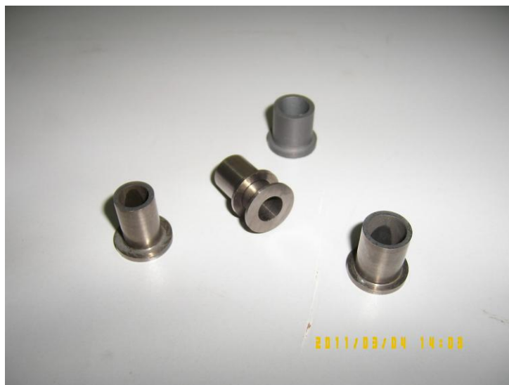
Рис. 5 Радиально-упорные подшипники скольжения для поворотных лопаток газотурбинного двигателя из композиционного материала на основе карбонитрида титана
