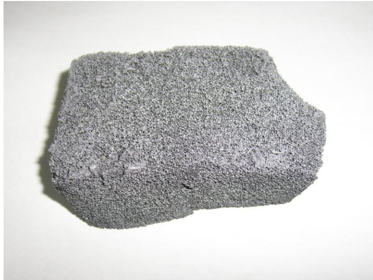
Рис. 5 Композиционный пенокарбид кремния для рассеивания и отражения тепловых потоков.
