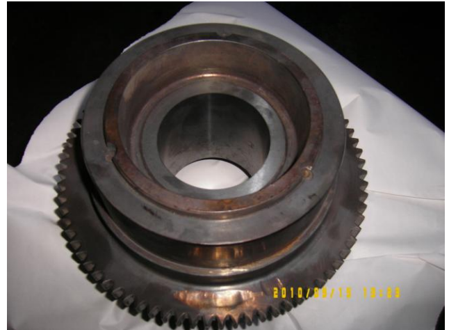
Рис. 7 Слева износостойкая втулка из наноструктурированного дисперсно-упрочненного карбида кремния для подшипника скольжения редуктора привода вентилятора авиационного двигателя НК-93 конструкции ОАО «Кузнецов».
