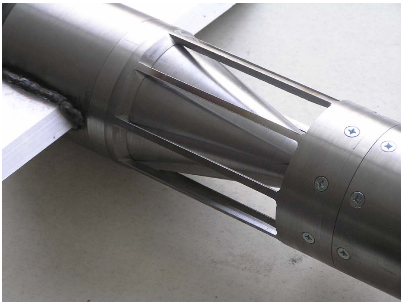
Рис. 2. Крепление корпуса к хвостовой части модели.
