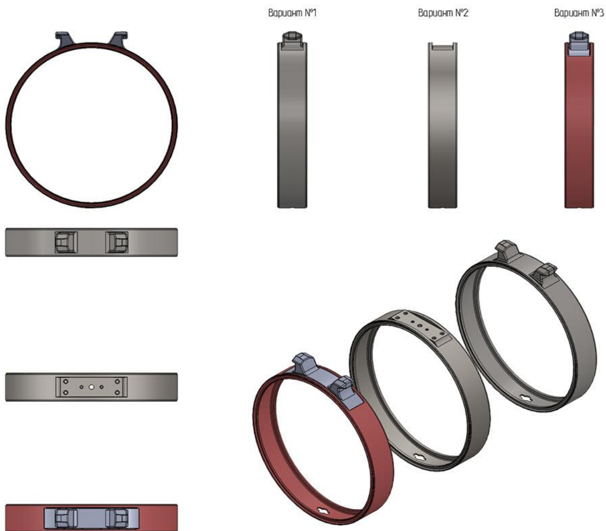
Рис. 5. Варианты конструкции шпангоута двигательного отсека противокорабельной ракеты. Вариант №1 – исходная конструкция. Вариант №2 – доработанная конструкция силами специалистов завода. Вариант №3 – предлагаемая конструкция
