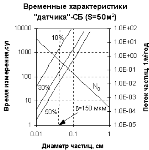
Рис. 4 – Характеристики «датчика» для измерения частиц различного размера
