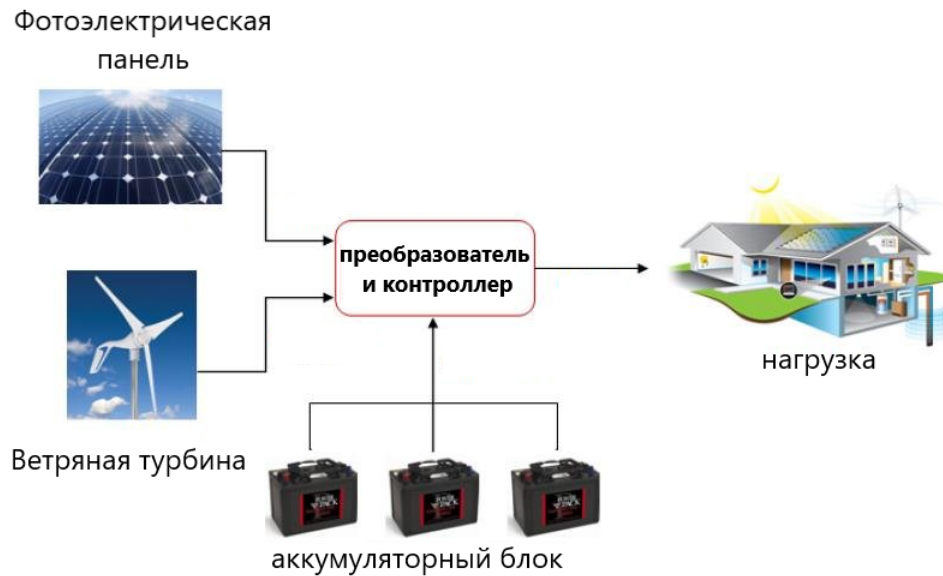
Рис. 2. Принципиальная схема гибридной солнечной, ветровой и накопительной системы выработки электроэнергии для дома.
