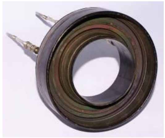
Рисунок 4 - Внешний вид многополостного анода-газораспределителя
