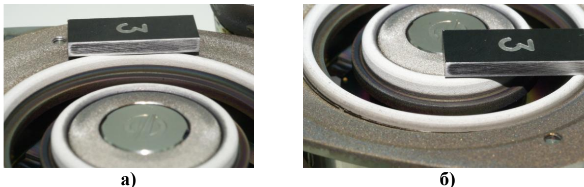
Рисунок 19 - Внешний вид поясков эрозии РК двигателя ПлаС-40 с мерным эталоном №3 а) наружная и б) внутренняя стенки РК
