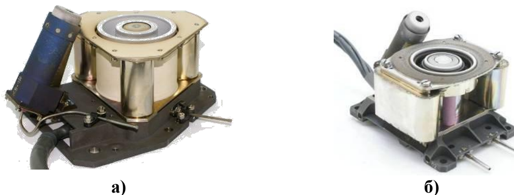
Рисунок 2 - Внешний вид двигателей а) СПД-50 и б) ПлаС-40
