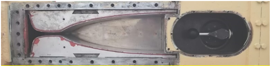
Рисунок 3 – Тракт рабочей части сверхзвуковой АТ СТ-3 Система крепления тензометрических весов в рабочей части сверхзвуковой АТ СТ-3 (для углов атаки от -10^\circ до +10^\circ ) представлена на рисунке 4.
