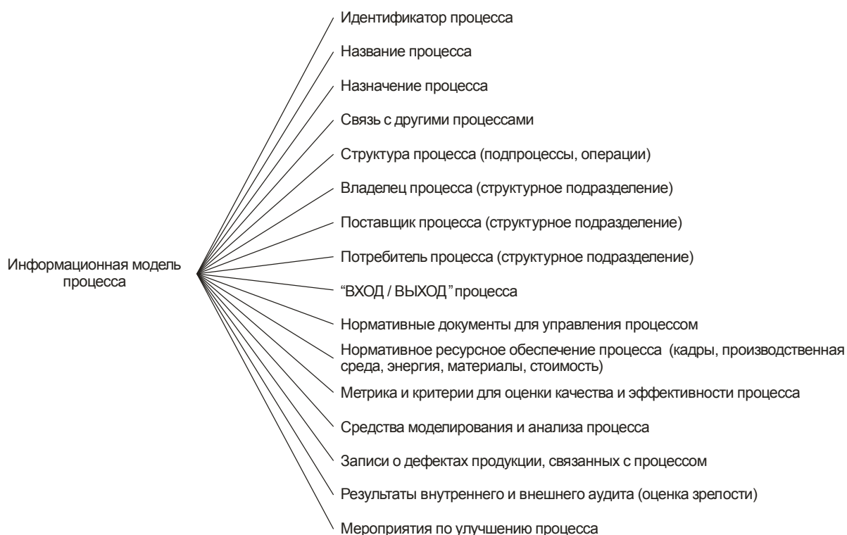
Рис. 4. Паспорт процесса как основа унифицированного метаописания процессов машиностроительного производства
