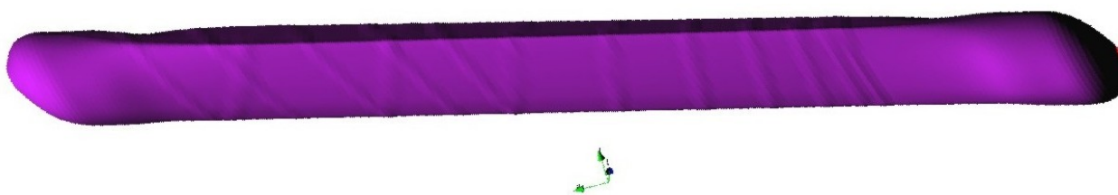
Рис. 5. Перестройка поверхности лонжерона стабилизатора вертолета после укладки нескольких витков ленты
