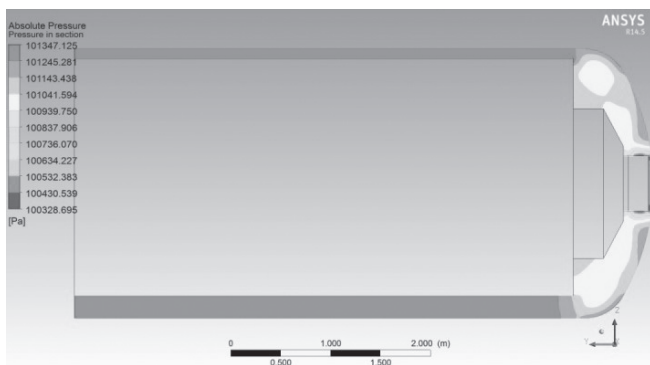
Рис. 11. Давление воздуха в центральном сечении автоклава
