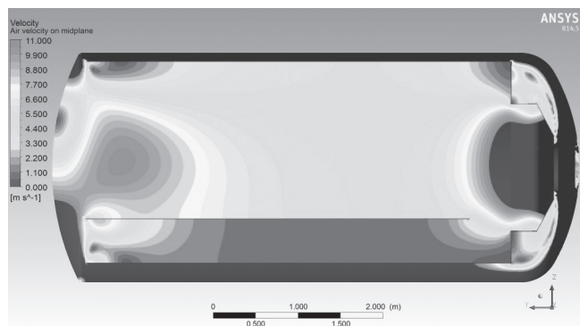
Рис. 15. Скорости воздуха в вертикальном сечении автоклава (показаны значения в диапазоне 0–11 м/с)
