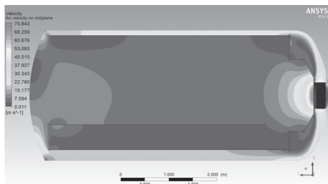
Рис. 14. Скорости воздуха в вертикальном сечении автоклава
