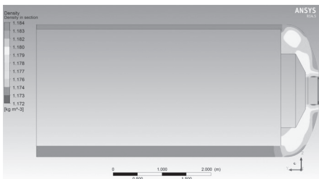
Рис. 12. Плотность воздуха в центральном сечении автоклава
