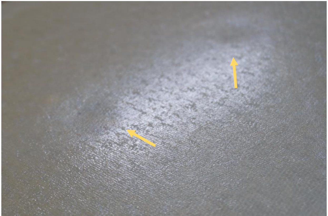
Рис. 4. Внешний вид вмятин (5-я, 6-я) на образце.
