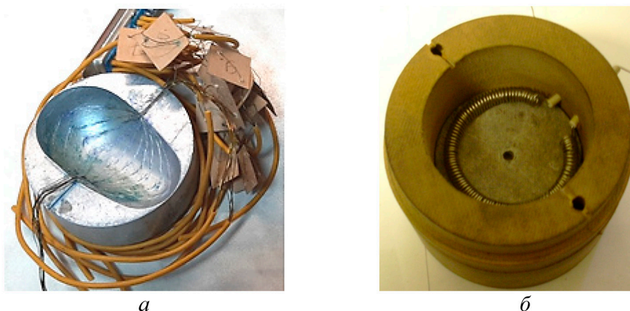
Рис. 5. Общий вид объекта исследования – модели диффузорной выемки, выполненной в измерительном вкладыше (а), и нагревателя (б) для электрометрического метода определения средней теплоотдачи в диффузорной выемке
