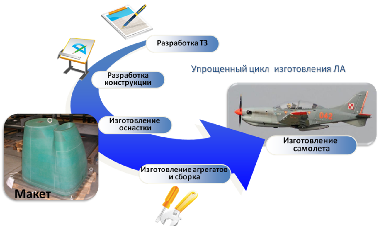
Рисунок 2 - Этап создания макета в цикле изготовления ЛА
