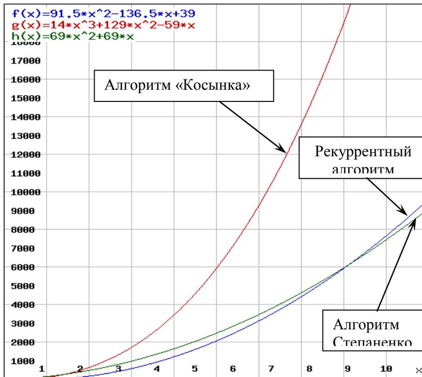
Рис. 2. Число операций, необходимое для вычисления матрицы обобщенной инерции, как функция числа звеньев простой кинематической цепи
