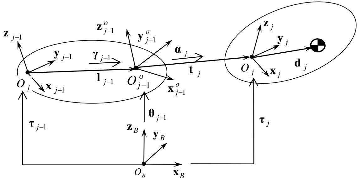
Рис.1 . Системы координат смежных тел простой кинематической цепи
