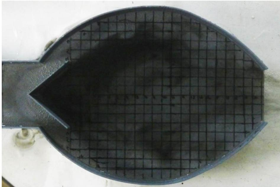
Рис. 2. Картина течения в КС в ходе гидродинамического эксперимента
