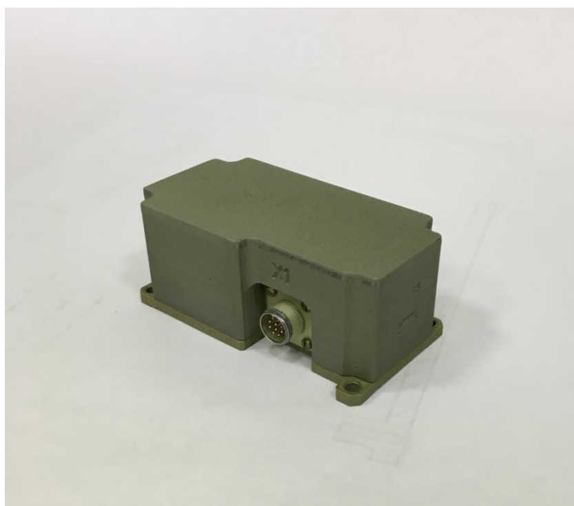
Рисунок 1. Гироинерциальный блок (ГИБ).
