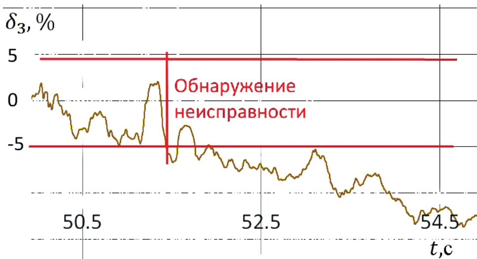
Рис. 3. Локализация неисправности. Отклонение силы, действующей на передний диск центробежного колеса насоса окислителя
