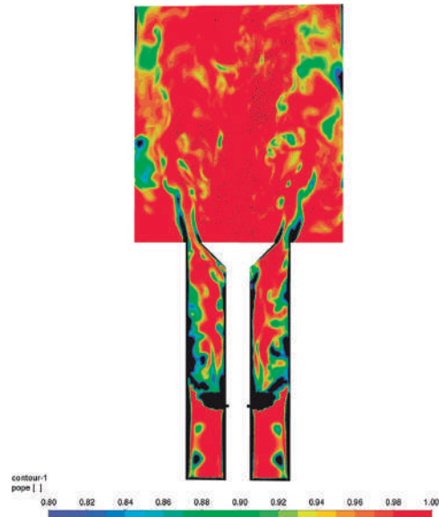
Рис. 3. Распределение значения критерия разрешения кинетической энергии турбулентности при моделировании крупных вихрей (Pope, 2004) [8]
