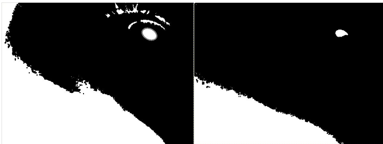
Рис 2. Направление взгляда – влево-вверх. Слева порог бинаризации равен 100, справа 30.
