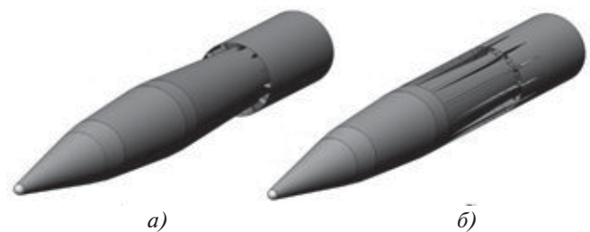
Рис. 2. Варианты ВЗУ калиберного кормового исполнения: a – без слива пограничного слоя; б – со сливом пограничного слоя
