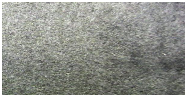
Рисунок 5. Внешний вид углерод-углеродного материала войлочного типа армирования
