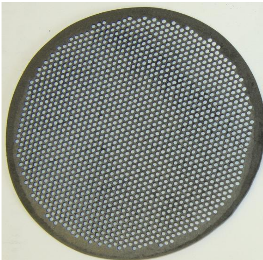
Рисунок 11. Плоский 100 мм эмиссионный электрод из УУКМ (промежуток между отверстиями 0,5 мм)
