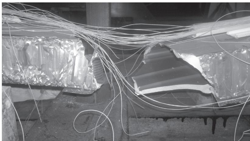
Рис. 4. Усталостное разрушение лопасти
