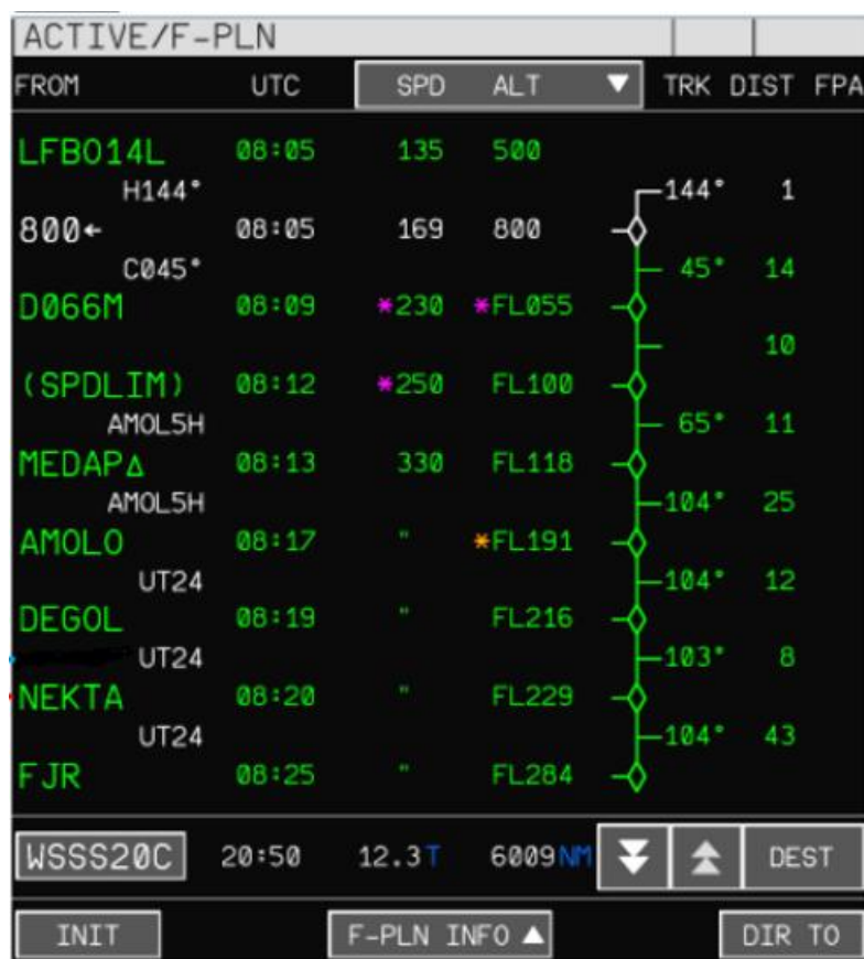
Рисунок 4 – Вид информационного кадра системы FMS самолёта Airbus A380 на широкоформатном дисплее.
